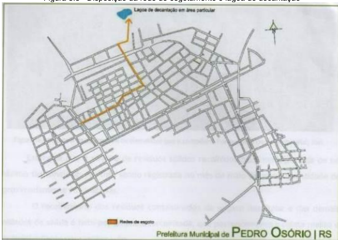
Figura 5.3 - Disposição da rede de esgotamento e lagoa de decantação
