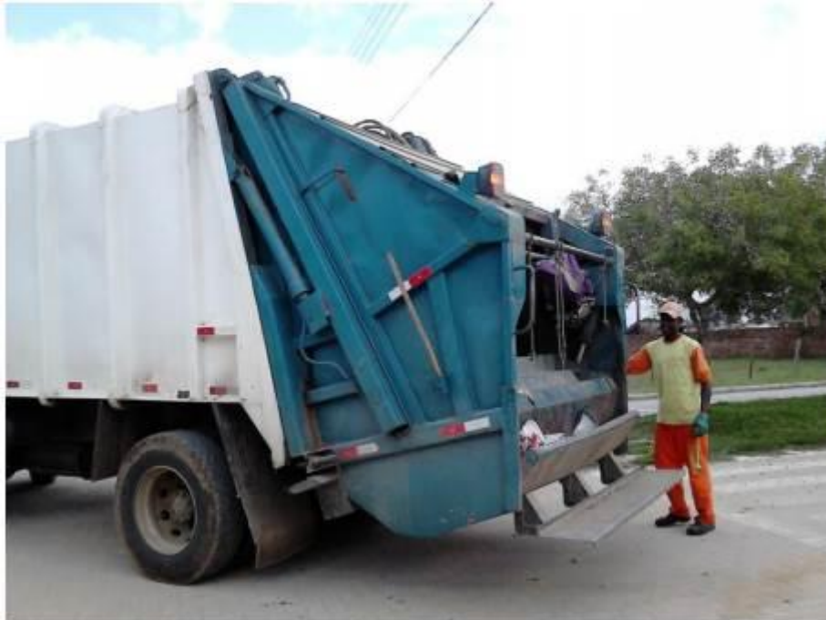
Figura 6.10 - Caminhão compactador utilizado para a coleta de resíduos sólidos
