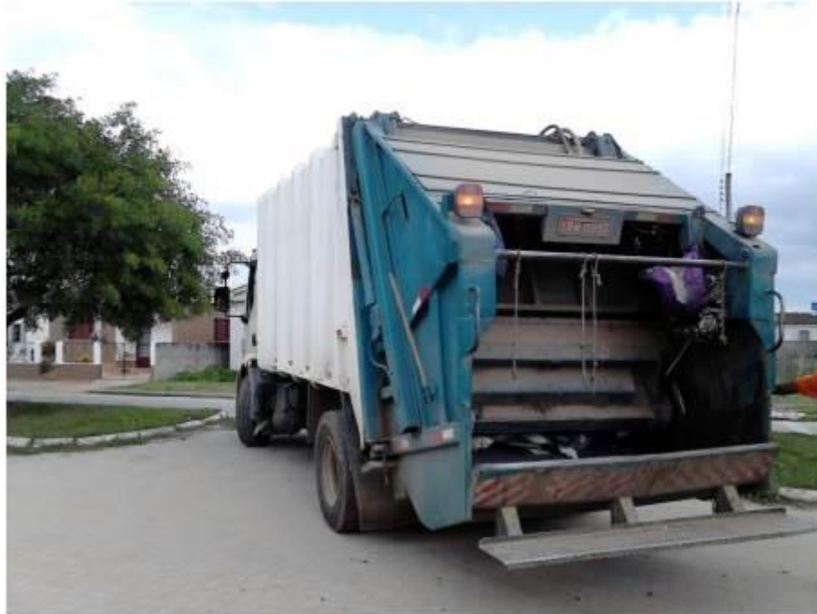
Figura 6.11 - Caminhão compactador utilizado para a coleta de resíduos sólidos
